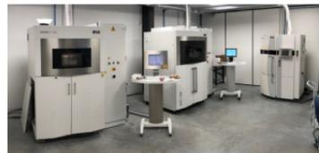
**Parc machines de production automatisée de pièces en frittage de poudre polyamide (technologie SLS).**
